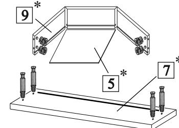
В накладку ящика вворачивается дюбель эксцентриковой стяжки. Ящик складывается согласно схеме, в паз вставляется дно, накладка стягивается с корпусом ящика.
